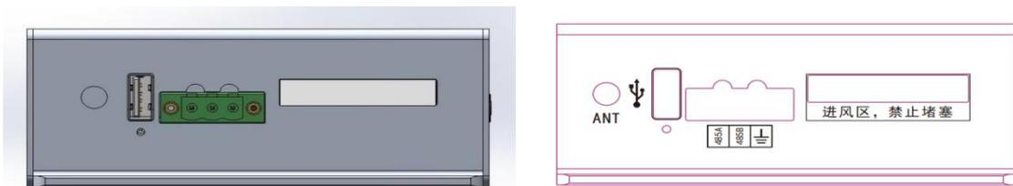
下图由左到右分别为 ANT 天线孔，USB 端口，485 端口，热解粒子进风区。
