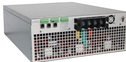
**产品概述：**有源电力滤波器，采用大功率高频电力电子开关元件——IGBT，组成三电平自换相H桥式电路，经过电抗器并联在电网上。直接控制桥式电路交流侧电流，实现对谐波电流的跟踪补偿。
