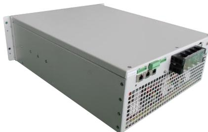
**产品概述：**采用大功率高频电力电子开关元件——IGBT，组成自换相桥式电路，经过电抗器并联在电网上。通过调节桥式电路交流侧电压幅值和相位，或者直接控制其交流侧电流，迅速发出容性或感性无功功率，实现动态无功补偿的目的。
