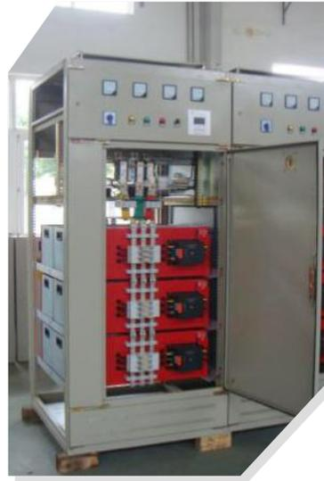
组装中的模块化低压无功补偿装置
